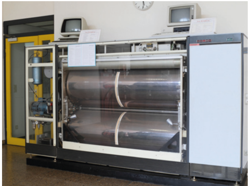
4 Großraummagnettrommelspeicher UNIVAC FASTRAND III aus dem Jahr 1969 im Eingangsfoyer der GWDG
