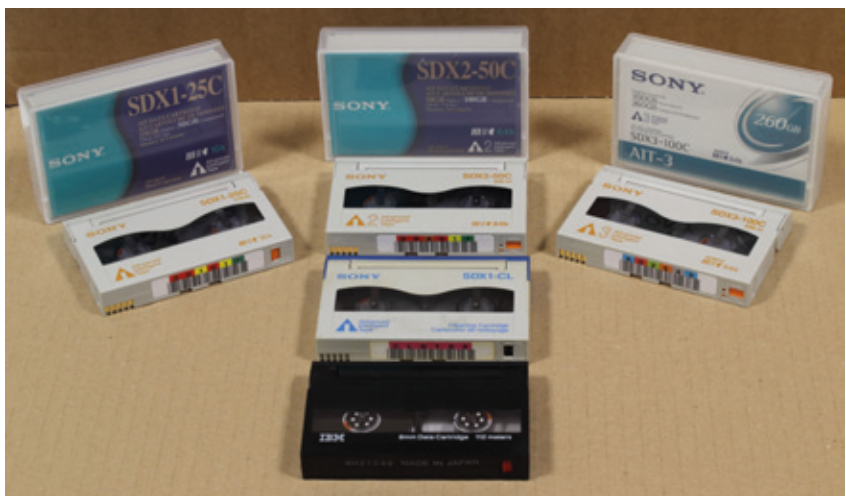
8 SONY AIT-(1,2,3)-Medien (zum Vergleich eine „Data8“-Kassette (im Vordergrund), dahinter eine SONY AIT-Reinigungskassette)
