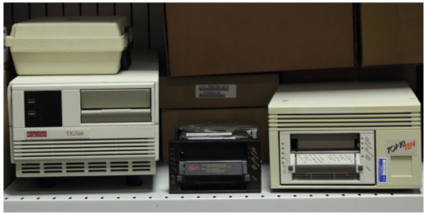
5 Lange nicht benutzte Kassettenlaufwerke (von links: DEC TKZ60 („IBM 3490“-kompatibel), DLT8000 (DLT IV), DLT2000 (DLT III))
