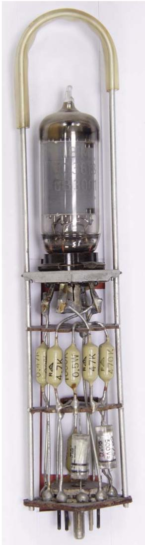
**Abb. 9: Flip-Flop-Röhrensteckeinheit der IBM 650**
