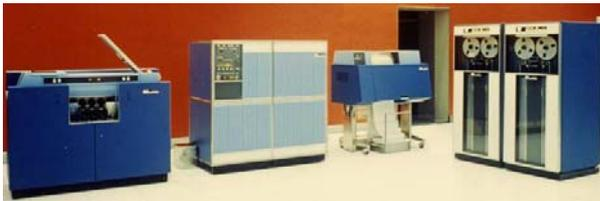
Abb. 17: Von links nach rechts: IBM 1402, IBM 1401, IBM 1403, 2x IBM 729
